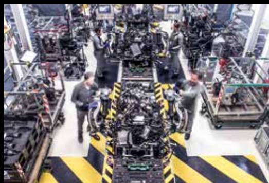
De gemoderniseerde fabriek in Crewe heeft een volledig geïntegreerde voertuigproductie en biedt onderdak aan alles wat bij een autofabriek hoort. Vroeger werden er in Crewe alle 12-cilindermotoren van de VW-Groep gebouwd.
